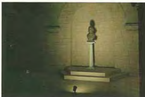
Réflecteur 22 degrés + diffuseur
